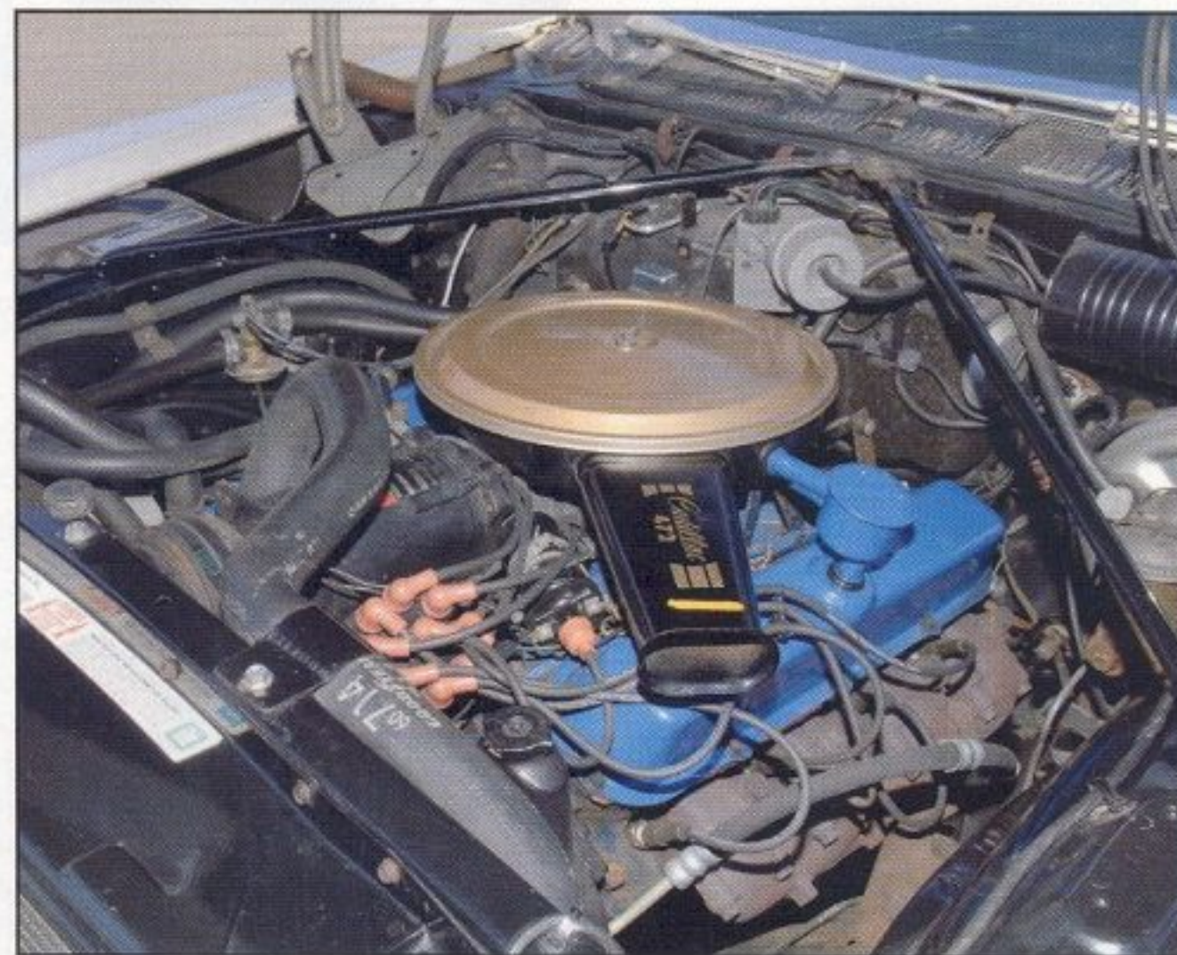
Größter und drehmomentstärkster US-Motor 1968: der neu entwickelte 7,7-Liter-V8 mit 375 PS
